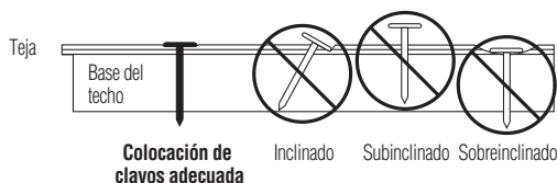
Figura 15-5: Colocación de clavos correcta e incorrecta
